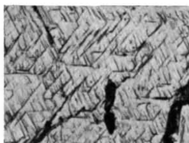
Fig. 2. Be(001) cleavage face ( \times 130 ).
